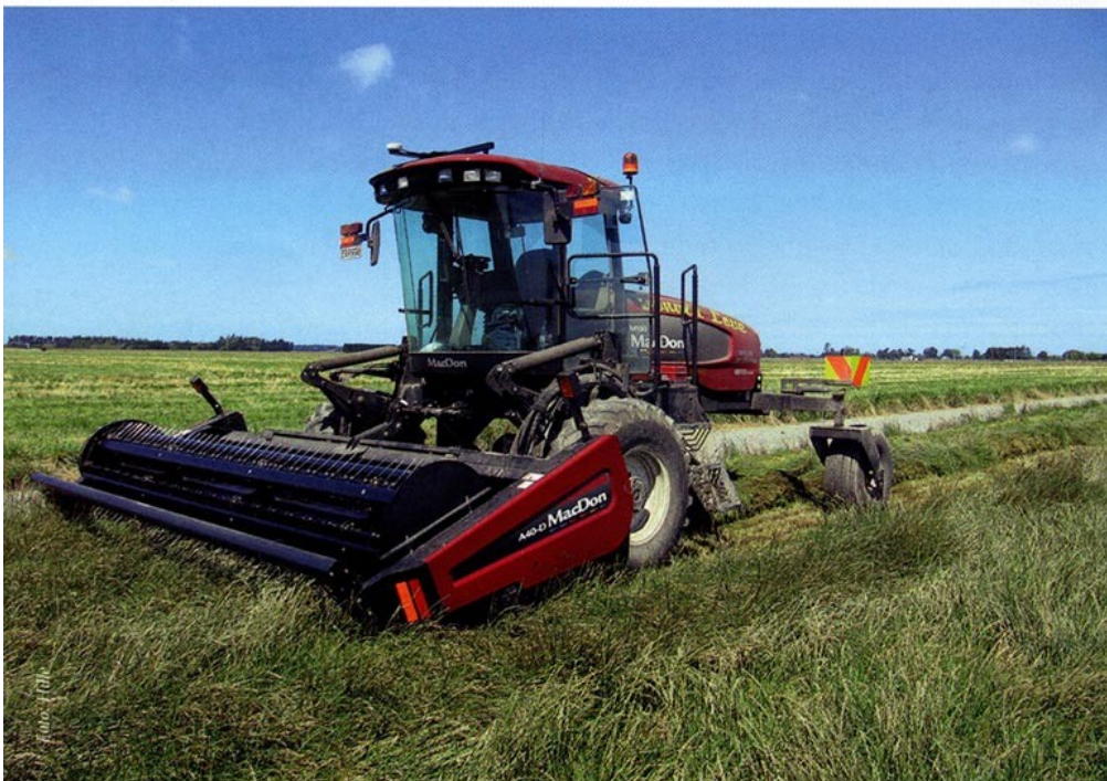
Schwadmäher mit 4,5 m Schneidwerk in der Grassamenvermehrung, 2-3 Wochen vor dem Drusch.
