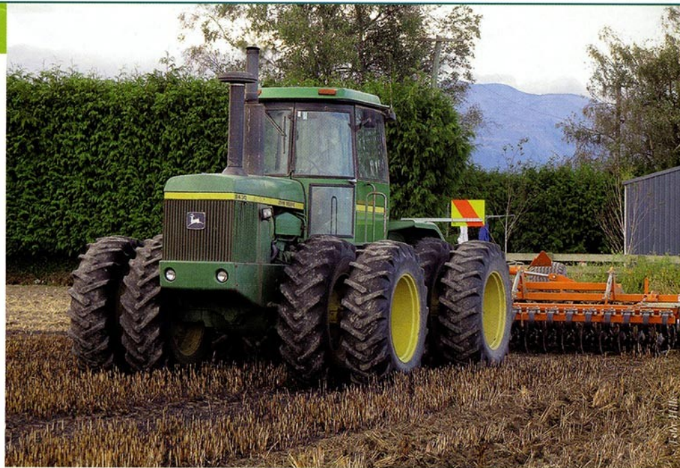
Schlagkräftige Stoppelbearbeitung mit der Kurzscheibenegge von Simba.
